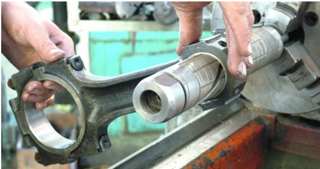
Рисунок 1 – Виготовлення клемового з'єднання
