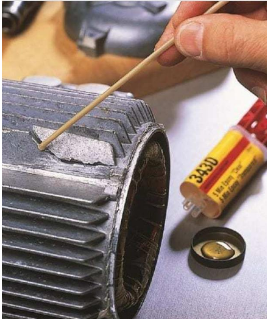
Рисунок 85 – Ремонт склеюванням металевих виробів
