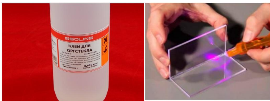
Рисунок 83 – Склеювання деталей з оргскла
