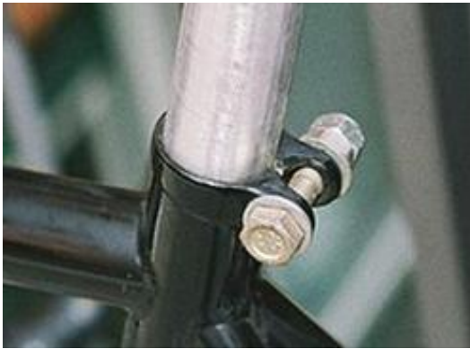
Рисунок 2 – З'єднання сидла велосипеда з рамою (маточина має прорізь)
