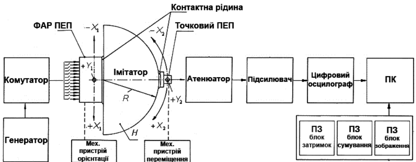
Рис. 8. Структурна схема розробленої системи вимірювання ПЧХ ультразвукових лінійних ФАР з індивідуальним збудженням п'єзоперетворювачів
