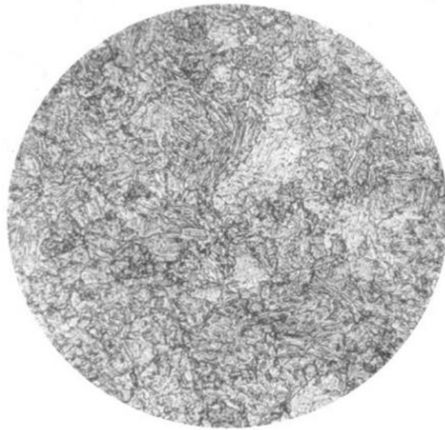
Рисунок 1.12 – Мікроструктура металу ГЦТ після 100 год експлуатації, збільшення 500
