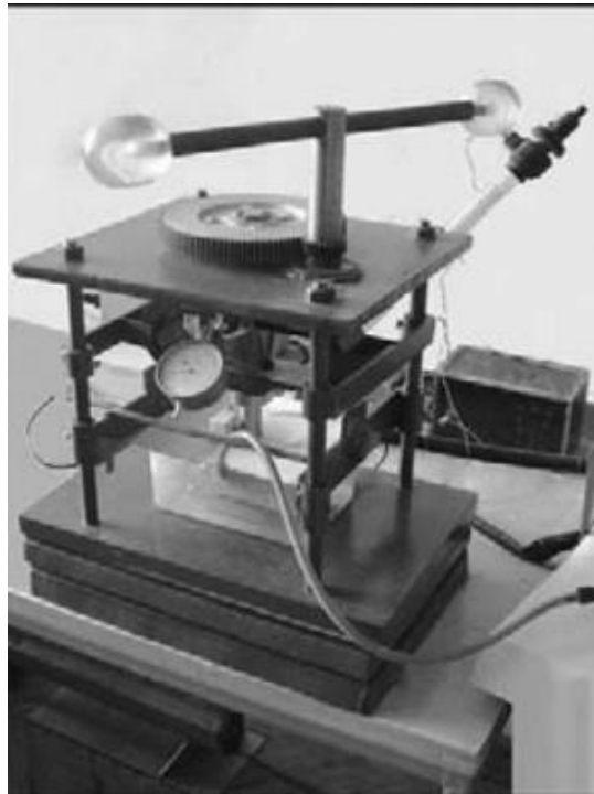
Рисунок 1.10 – Зовнішній вигляд випробувальної машини для визначення параметрів SCCRD
