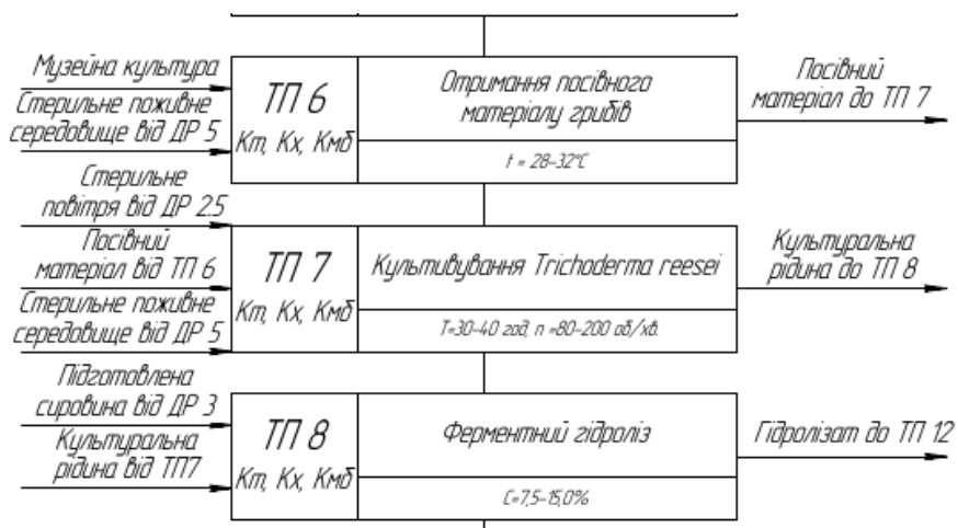
Рисунок 3 – Приклад зображення стадії процесу на технологічній схемі
