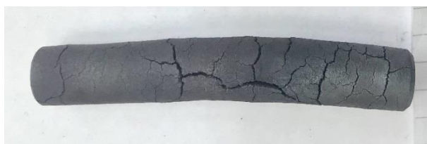
Рисунок 3.8 – Зовнішній вигляд зразка із чавуну марки 310ЖЧС5 після 10-60 циклів.
