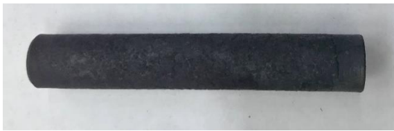
Рисунок 3.11 – Зовнішній вигляд зразка із чавуну марки 350ЖЧСЗЮХМН після 10-60 циклів
