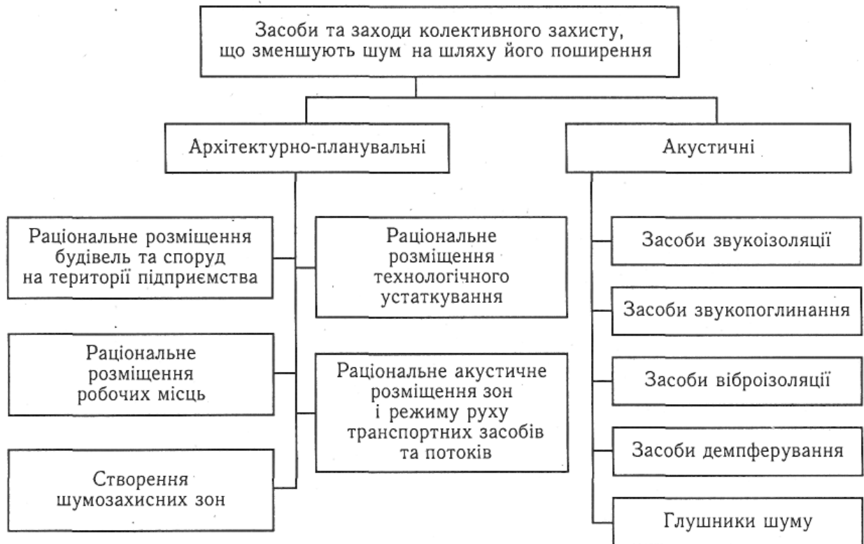
Рисунок 5.2 - Класифікація засобів та заходів колективного захисту, що зменшують шум на шляху його поширення
