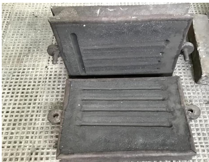
Рисунок 2.1 – Загальний вигляд ливарної форми
