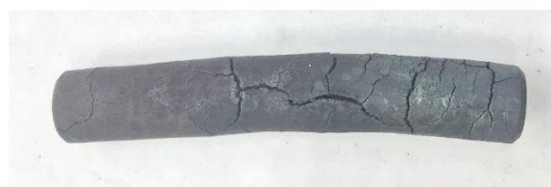
Рисунок 3.8 – Зовнішній вигляд зразка із чавуну марки 310ЖЧС5 після 10-60 циклів.
