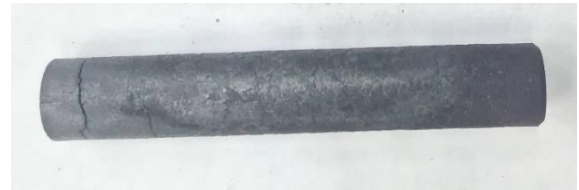
Рисунок 3.11 – Зовнішній вигляд зразка із чавуну марки 350ЖЧСЗЮХМН після 10-60 циклів
