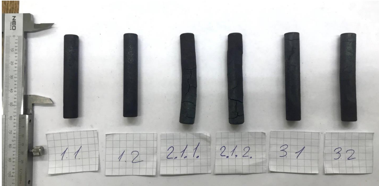
Рисунок 3.13 – Загальний вигляд зразків після термоцикування
