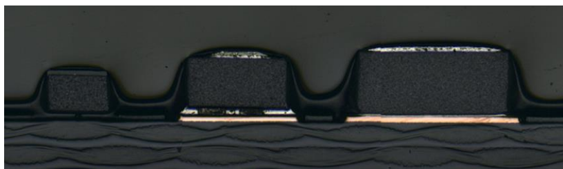
Рис.2.18. Приклад конформного покриття на електронних компонентах[37].
