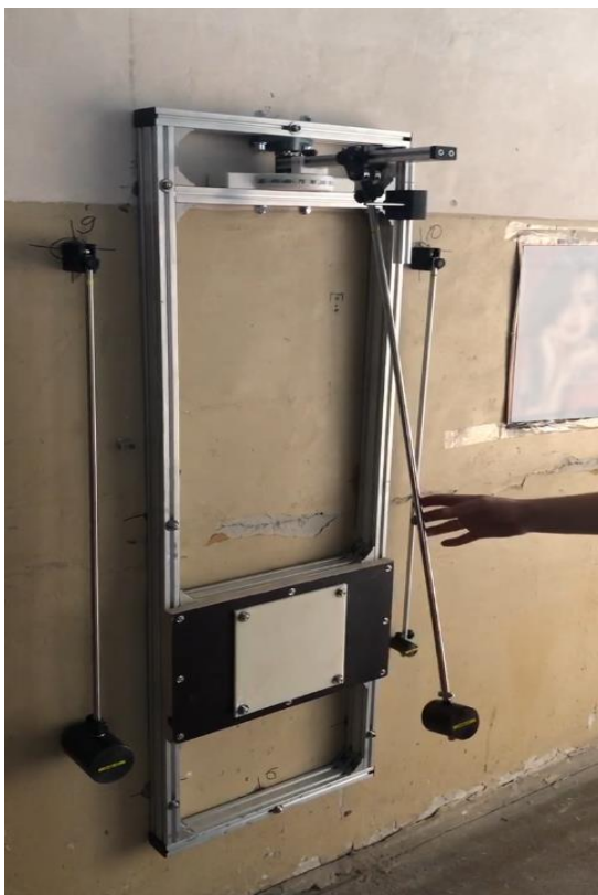
Рис.4.4. Використаний у випробуваннях ударний тестер для перевірки корпусу та плати на стійкість до падінь та ударів.
