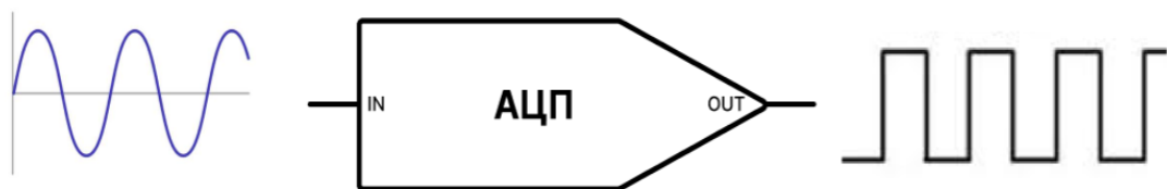
Рис.1.4. Принцип роботи аналогово-цифрового перетворювача.
