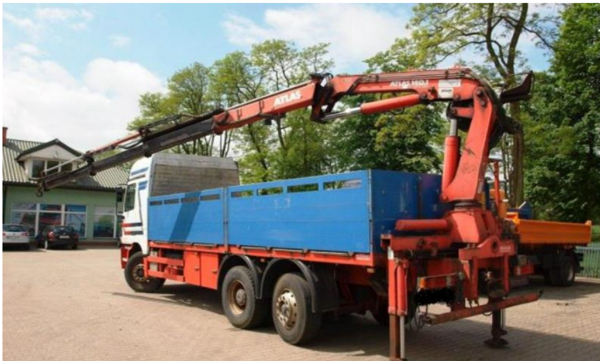
Рис. 1.11 - Гідравлічна Z-образна КМУ
