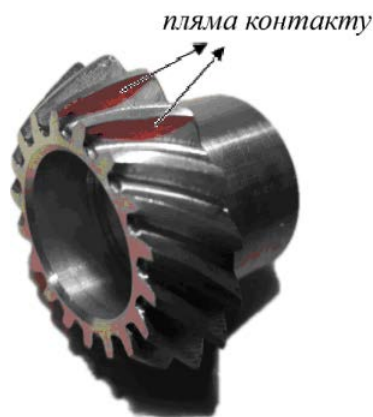
Рис.4.11 Конічна шестерня з плямою контакту
