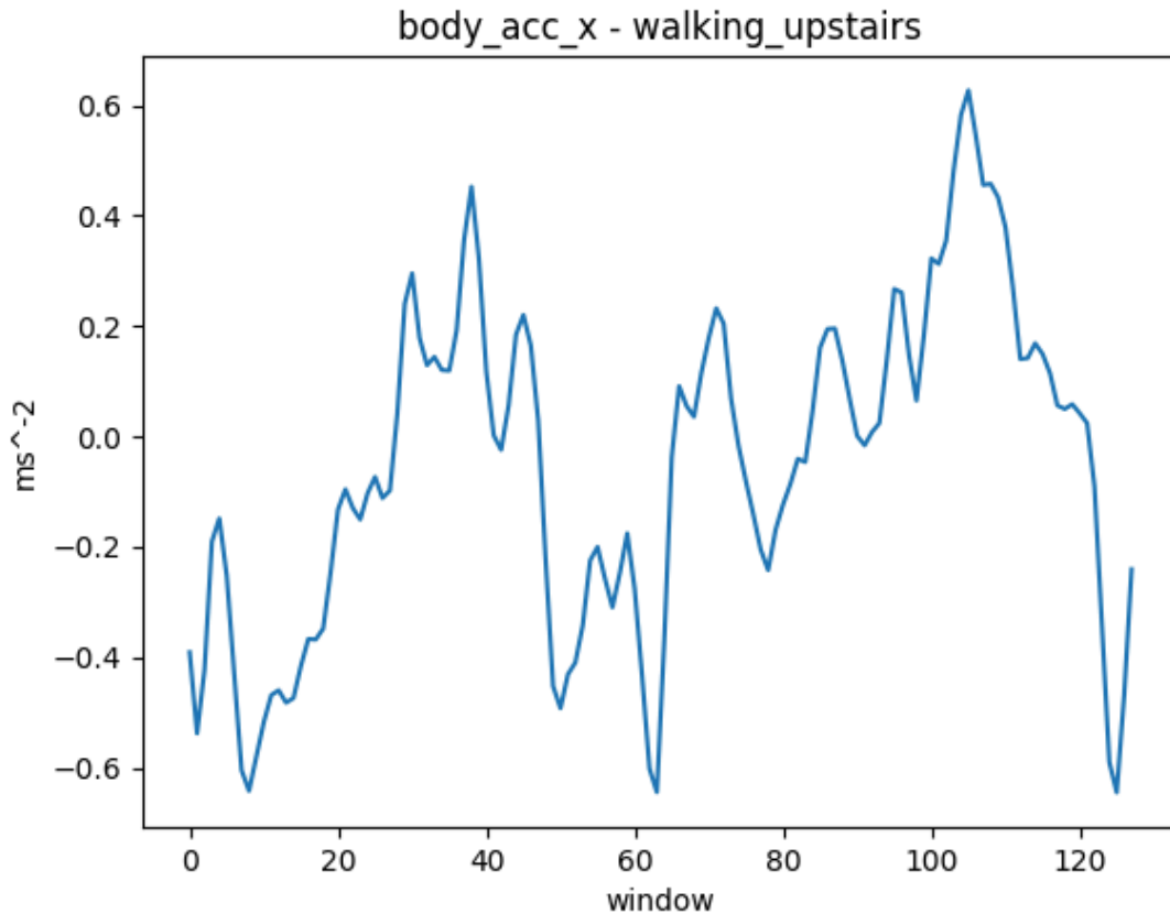
Рисунок 2.2 Приклад даних з акселерометра по осі X під час підйому по сходах
