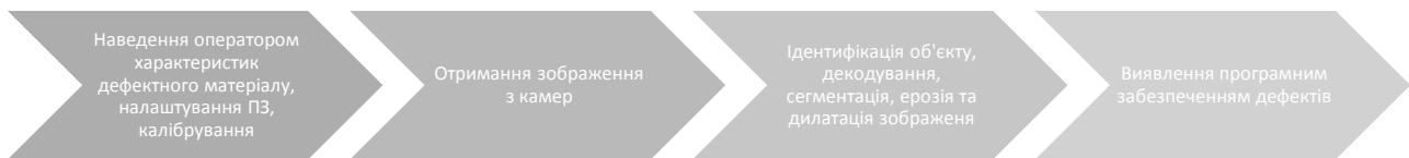
Рисунок 2. Етапи визначення дефекту виробу комп'ютерним зором
