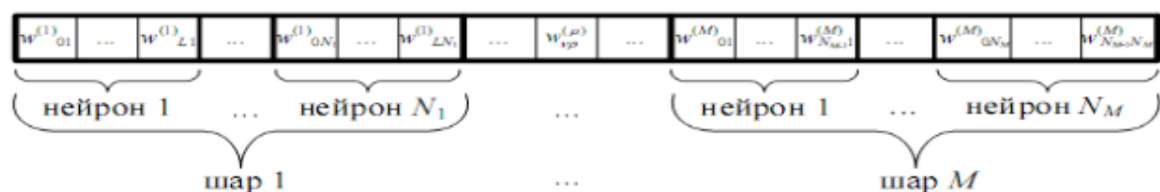
Рисунок 4.3 – Схематичне подання хромосоми при параметричному синтезі нейромоделей[12]
