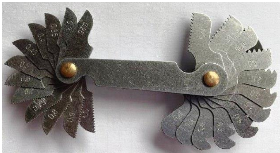
Рис. 4.5. Різьбомір (шаблон різьбовий) (зліва метрична, справа дюймова)
