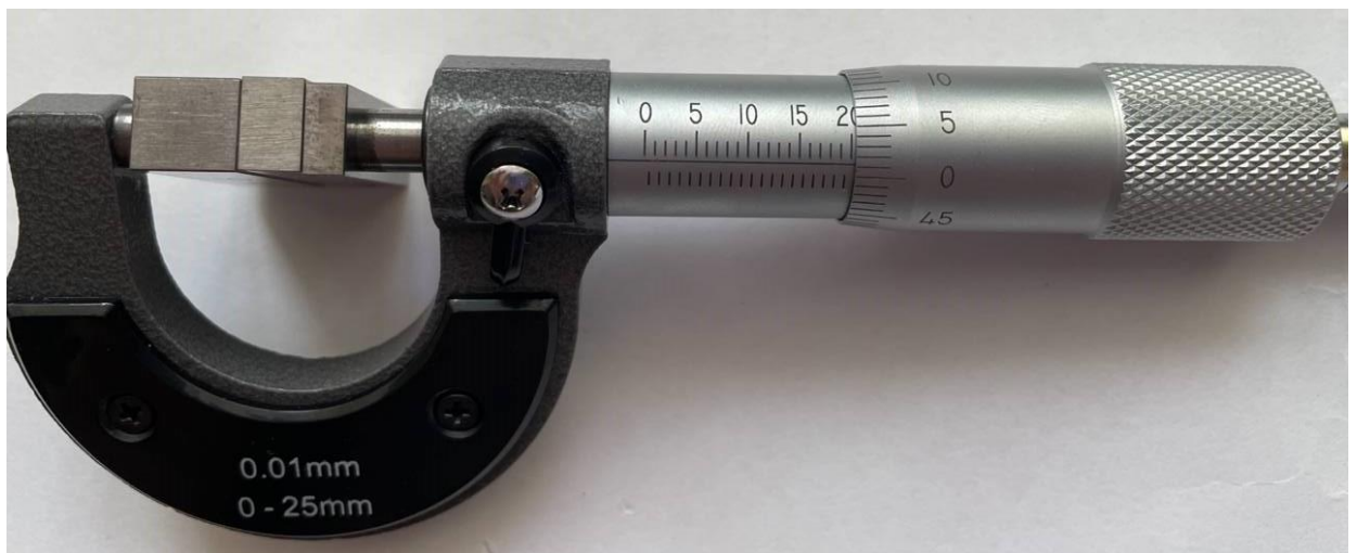
Рис.3.2. Приклад повірки мікрометра в точці 20 мм
