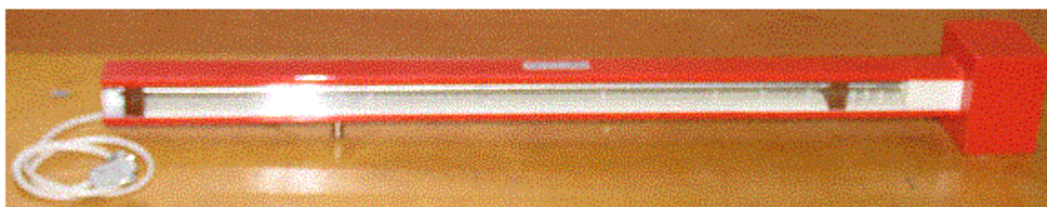
Рисунок 3.1. Зовнішній вигляд експериментальної установки для визначення локальних і середніх по довжині труби значень коефіцієнта тепловіддачі при вимушеному русі повітря в трубі
