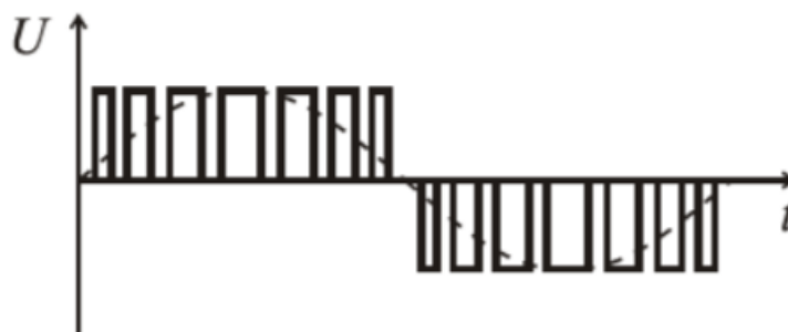
Рис.1.8 Синусоїдальна широтно-імпульсна модуляція
