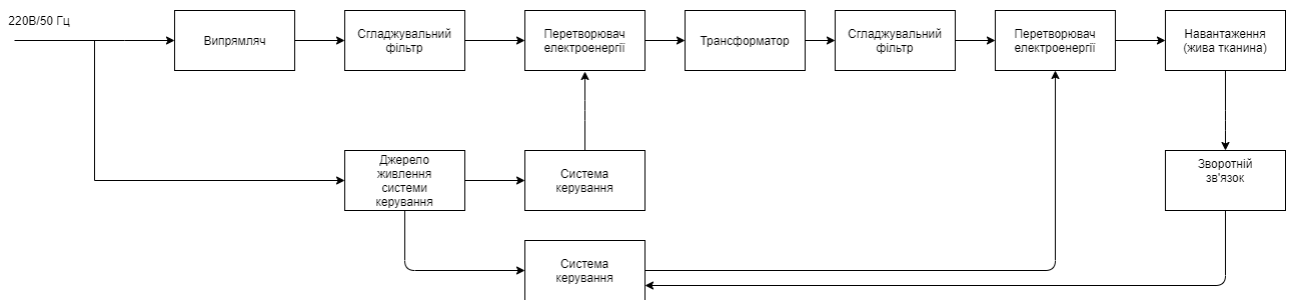
Рис.2.1 Структурна схема джерела живлення для зварювання
