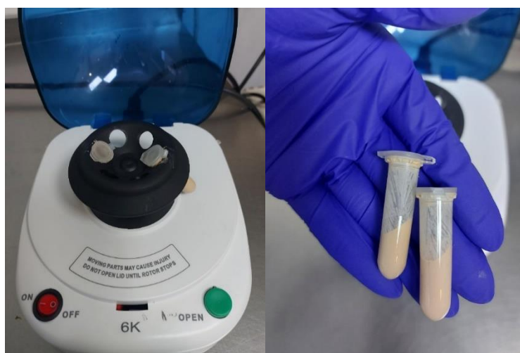
Рисунок 3.12 – Процес визначення стабільності емульсії
