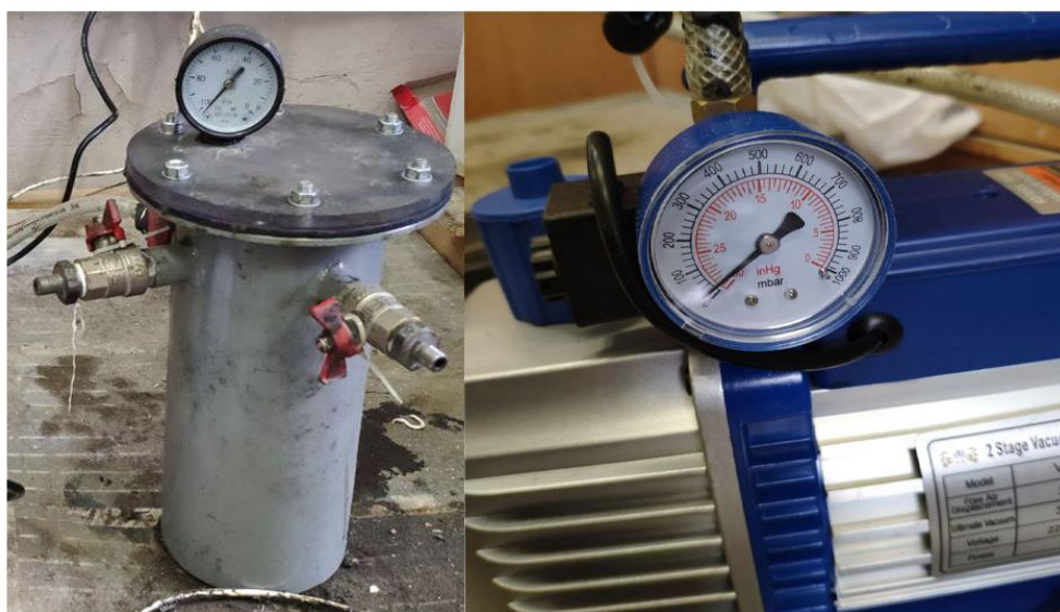
Рисунок 3.4 – Вакуумна установка для сушки композиту
