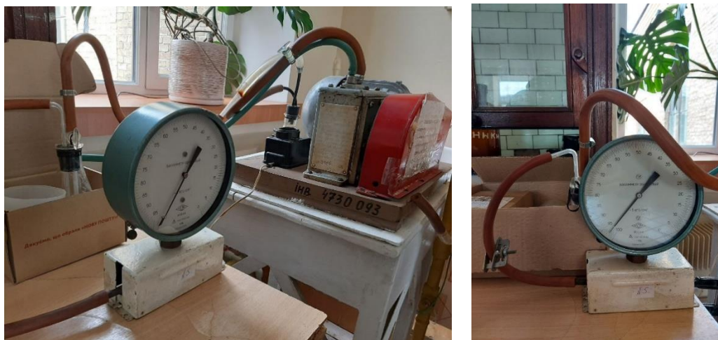
Рисунок 3.2 – Установка для вакуумування
