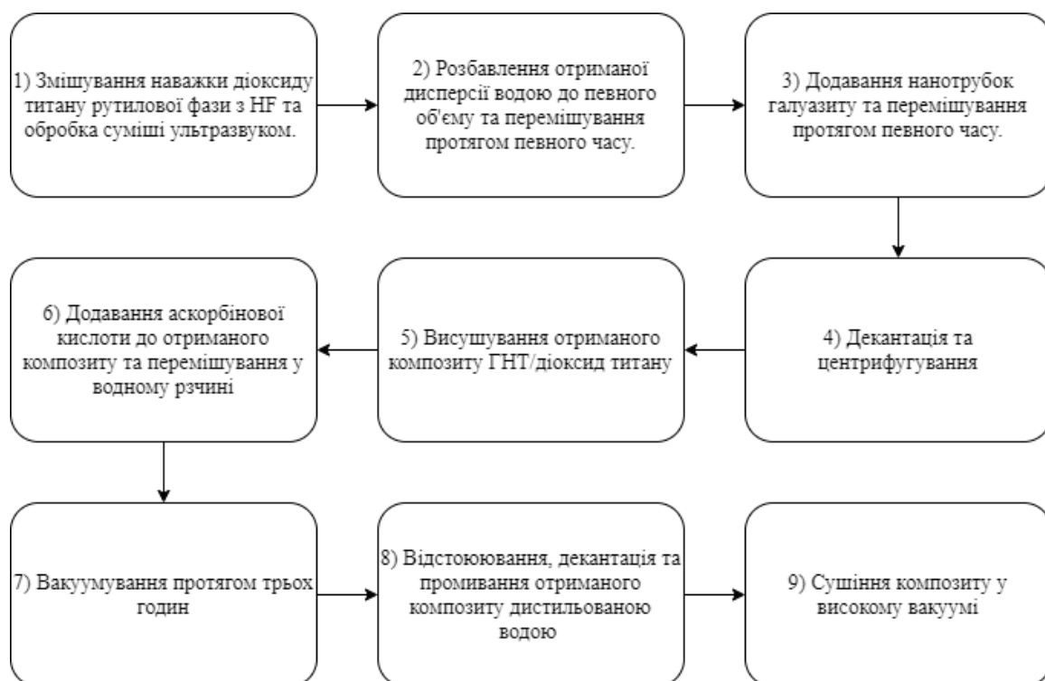
Рисунок 3.1 – Схема синтезу композитних матеріалів ГНТ/аскорбінова кислота/ \text{TiO}_2
