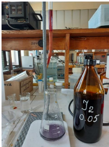
Рисунок 3.3 – Процес титрування аскорбінової кислоти йодом
