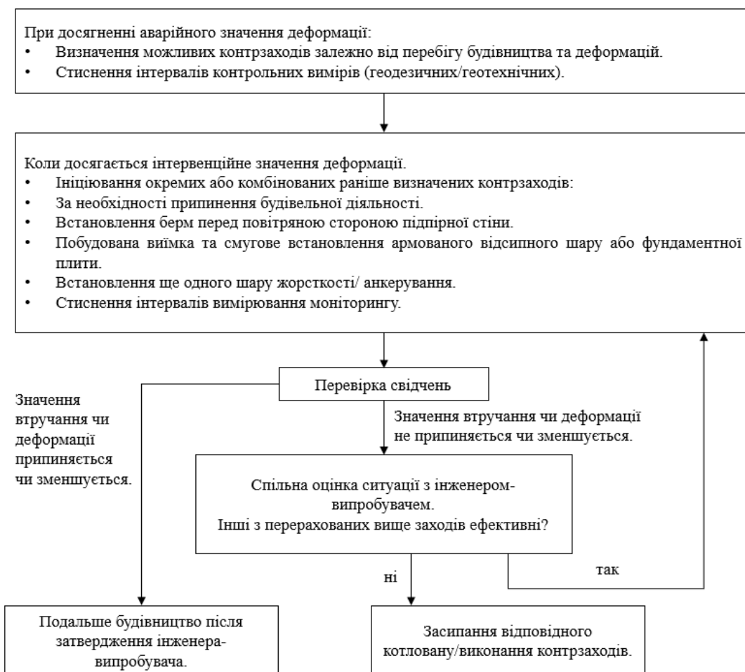
Рисунок 2.3.1 – Схема плану дій при досягненні аварійного значення деформації
