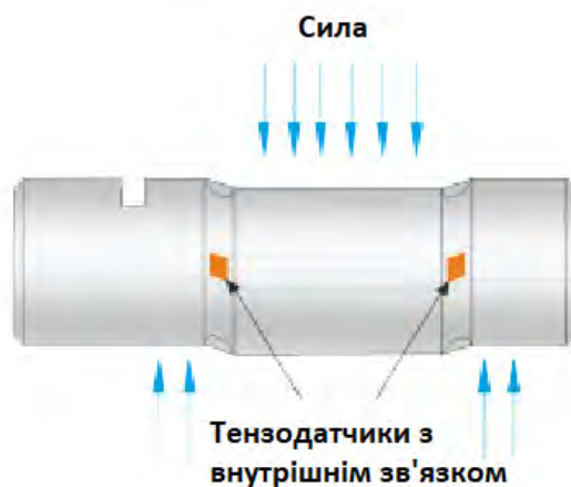
Рисунок 2.2.3.1 – Принцип роботи штифта
