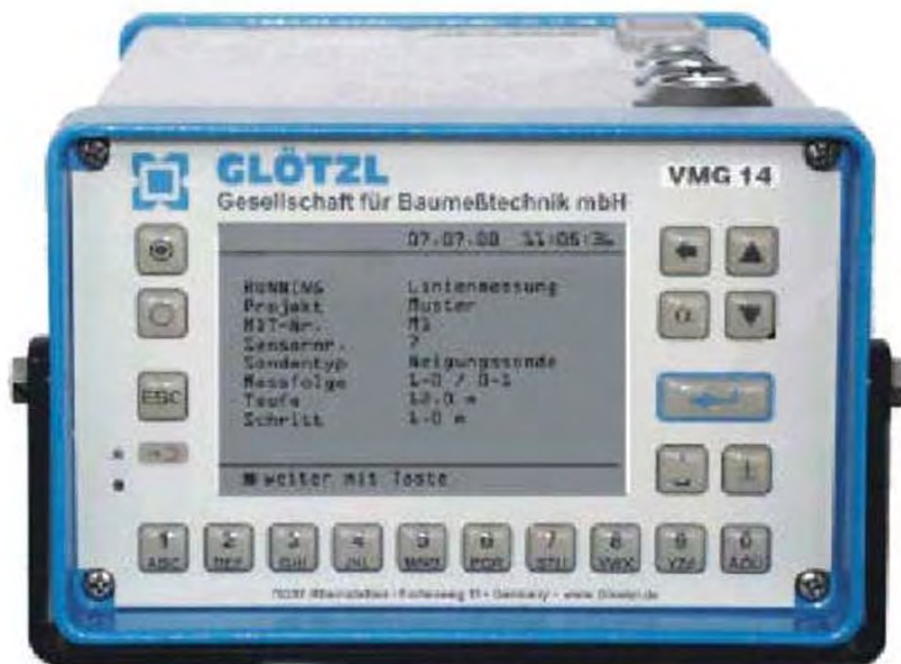
Рисунок 2.2.2.2 - Передня панель та розкладка клавіатури
