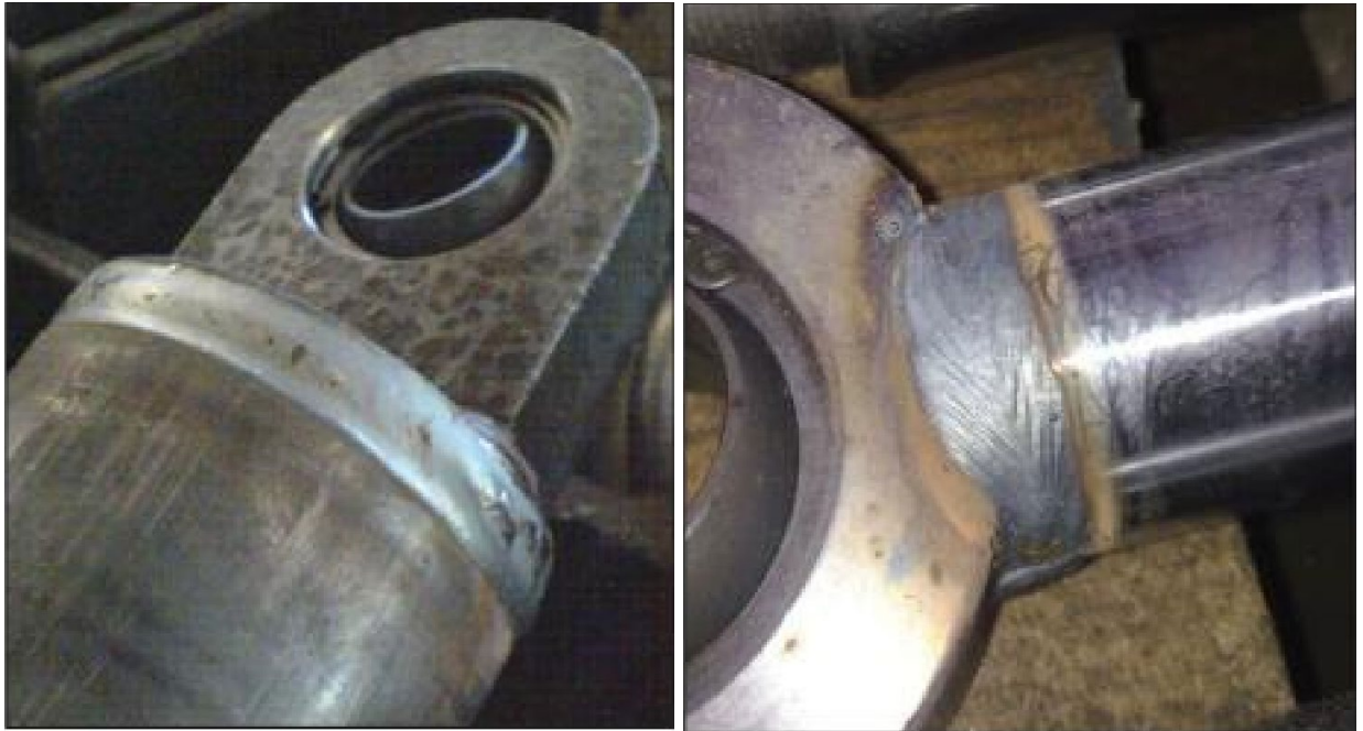
Рис. 1.2 – Приклади швів, отриманих з допомогою вітчизняної зварювальної установки АС305-1М
