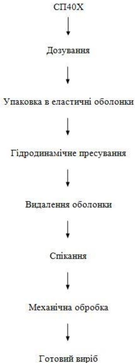
Рисунок 1.3 – Технологічна схема отримання без пористих конструкційних матеріалів методом гідродинамічного пресування
