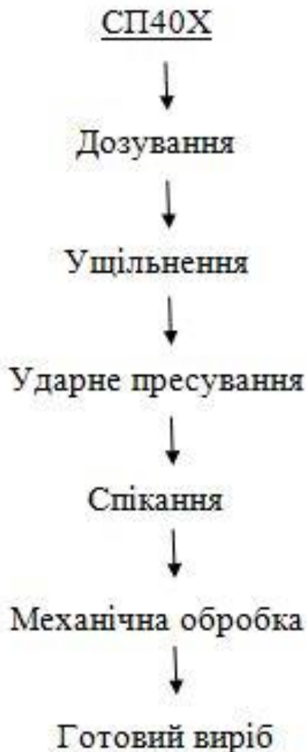
Рисунок 1.2 – Технологічна схема виготовлення без пористих конструкційних матеріалів ударним пресуванням
