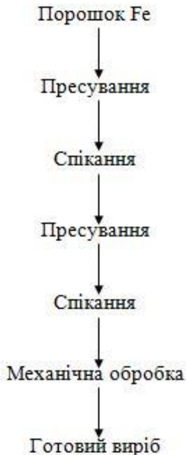
Рисунок 1.6 – Технологічна схема виготовлення без пористих конструкційних матеріалів подвійним пресуванням і спіканням
