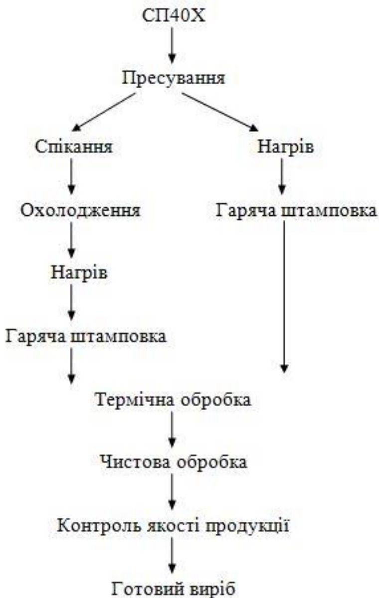
Рисунок 1.5 – Технологічна схема виготовлення без пористих конструкційних матеріалів гарячою штамповкою
