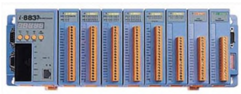
Рис. 11.11. Зовнішній вигляд ПЛК I-8837
