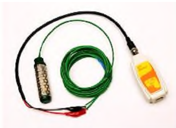
Рис. 8.25. Датчик вологості ґрунту DT171A: датчик вологості WATERMARK; адаптер Fourier; BNC-конектор
