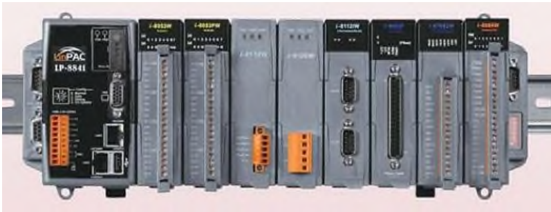
Рис. 11.8. ПЛК з модульною структурою
