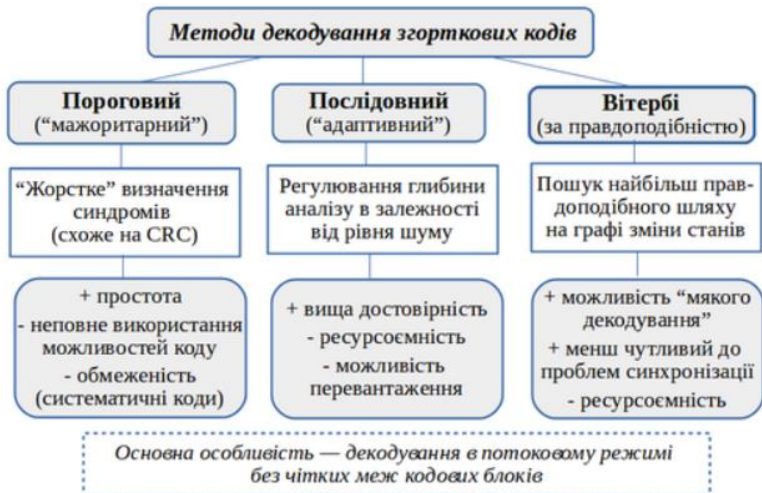
Рисунок 3.8 - Огляд напрямків декодування згорткових кодів
