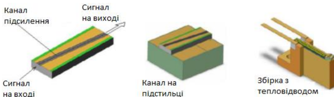
Рисунок 4.33 - Конструктивне оформлення НПОП зі скошеним каналом посилення для виключення відбитих хвиль
