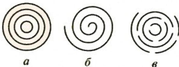
Рис. 11. Строение многослойных трубок: а - коаксиальная; б - спиральная; в - папье-маше
