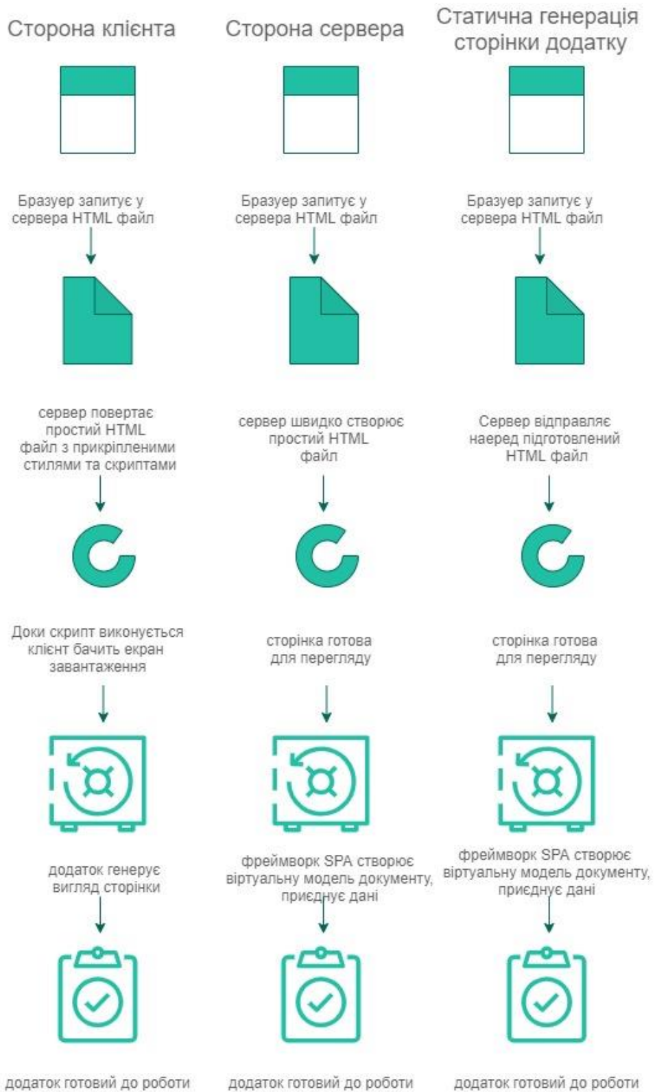
Рис. 3.2 – Принцип роботи SPA застосунку
