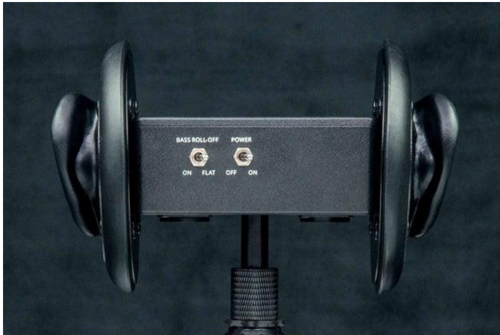
Рис. 10 — Задня панель штучної голови Free Space Pro II Binaural Microphone [21]
