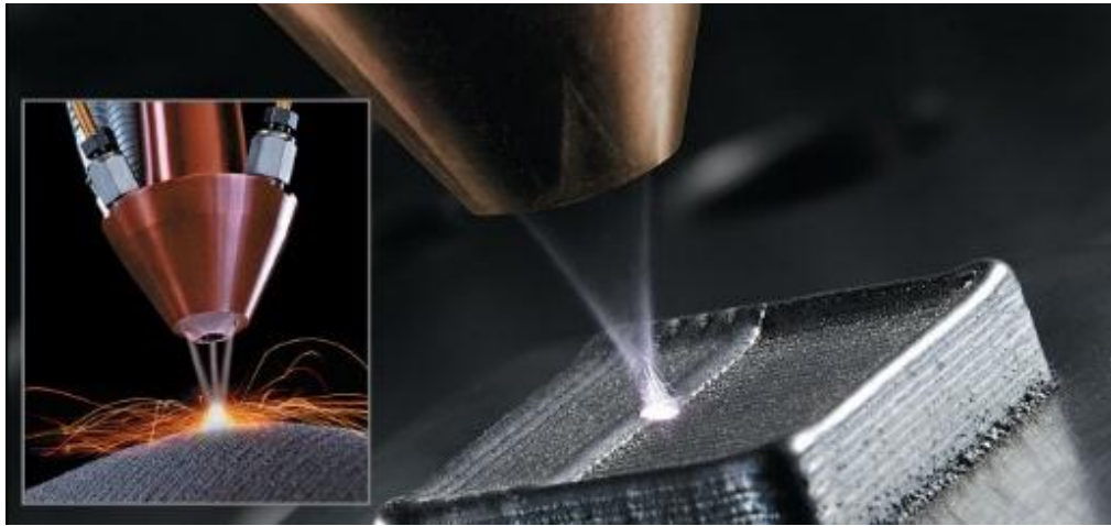
Рисунок 1.6 –Збільшений масштаб процесу послойного напилення металевого порошку в виробництві деталі за допомогою 3д-принтера [18]
