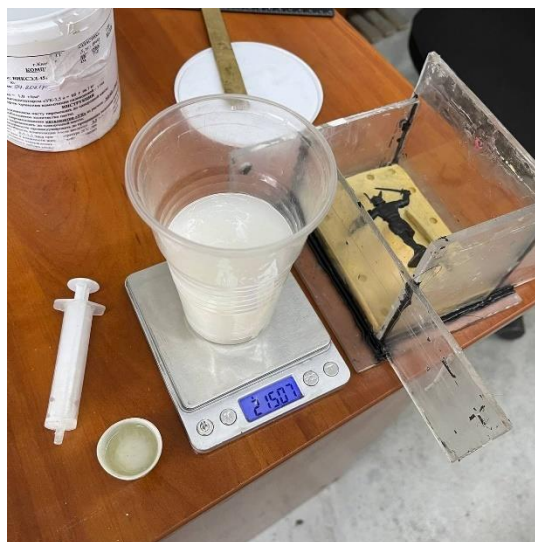
Рисунок 3.3 – Приготування силіконової суміші для заливання прес-форми
