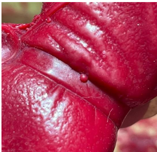
Рисунок 3.4 – Дефект поверхні у вигляді бульбашок повітря
