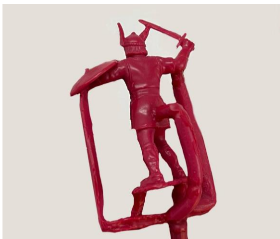
Рисунок 3.14 – Розташування додаткового живильника для виробу «Вікінг»
