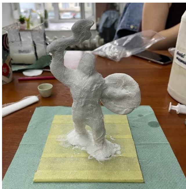
Рисунок 3.11 – Модель «Кельт» з 4 шарами каучуку та 2 шарами каучуку з бинтом
