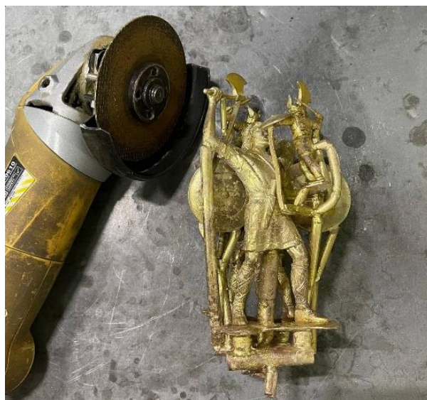
Рисунок 3.17 – Процес відокремлення виливків від ливникової системи
