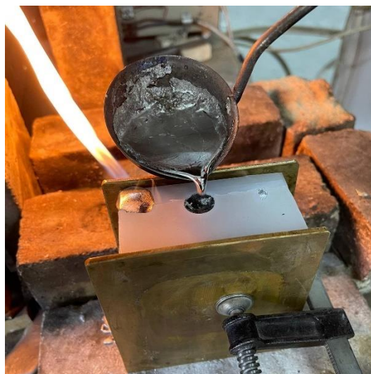
Рисунок 3.7 – Процес заливання металу в силіконову прес-форму
