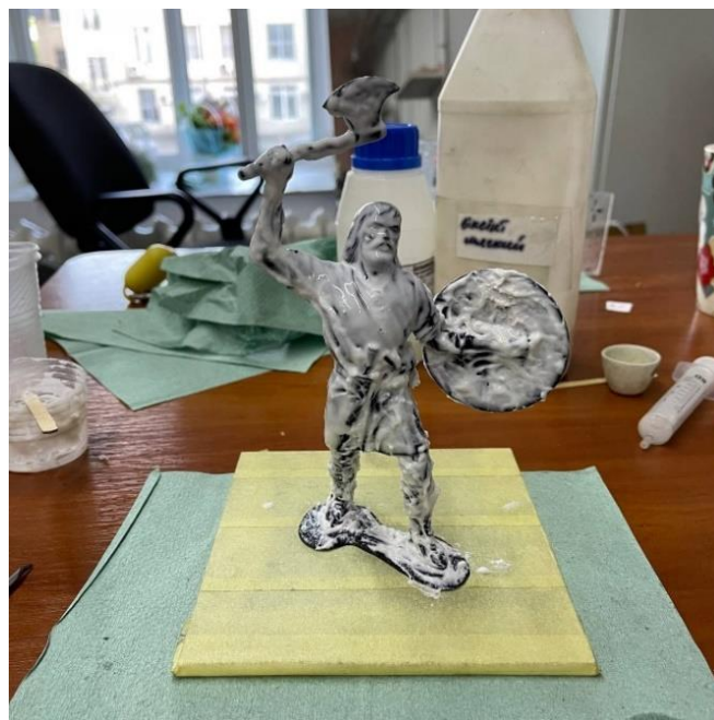
Рисунок 3.10 – Модель «Кельт» з першим шаром покриття із каучуку
