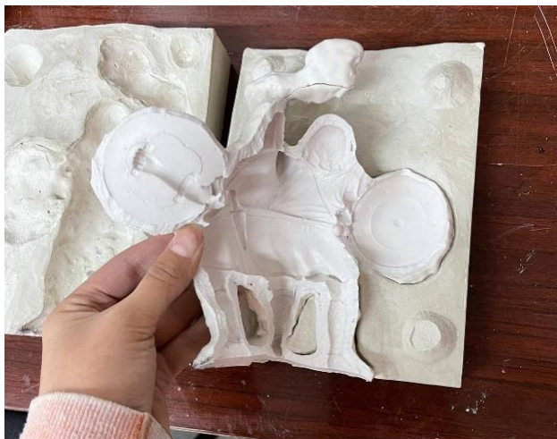
Рисунок 3.13 – Готова прес-форма для виливка «Кельт»
