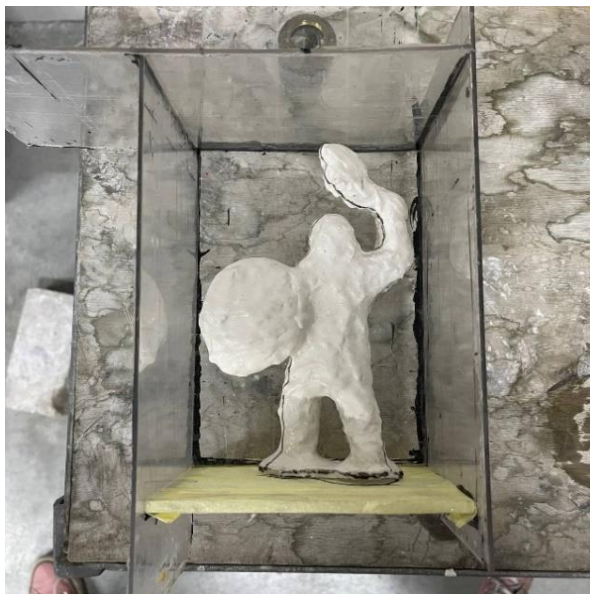
Рисунок 3.12 – Закріплена модель «Кельт» в оболонці з каучуку для заливання гіпсовою сумішшю
