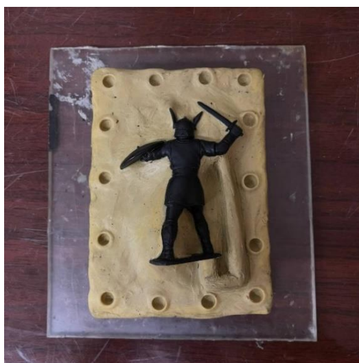
Рисунок 3.2 – Верхня фальшива півформа із пластиліну для виготовлення силіконової прес-форми для виливка «Вікінг»
