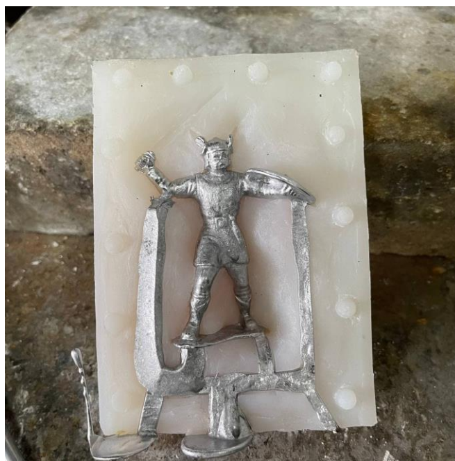
Рисунок 3.8 – Готовий виливок «Вікінг» із олов'яно-свинцевого сплаву
