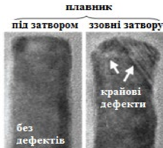
Рисунок 1.9 – Пошкодження імплантацією та проблема рекристалізації [8]
