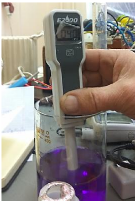
Рисунок 2.4 – Вимір електропровідності підготовленого розчину.
