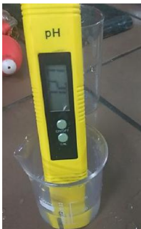
Рисунок 2.14 – Вимір рівня рН модельного розчину метилфіолетового.
