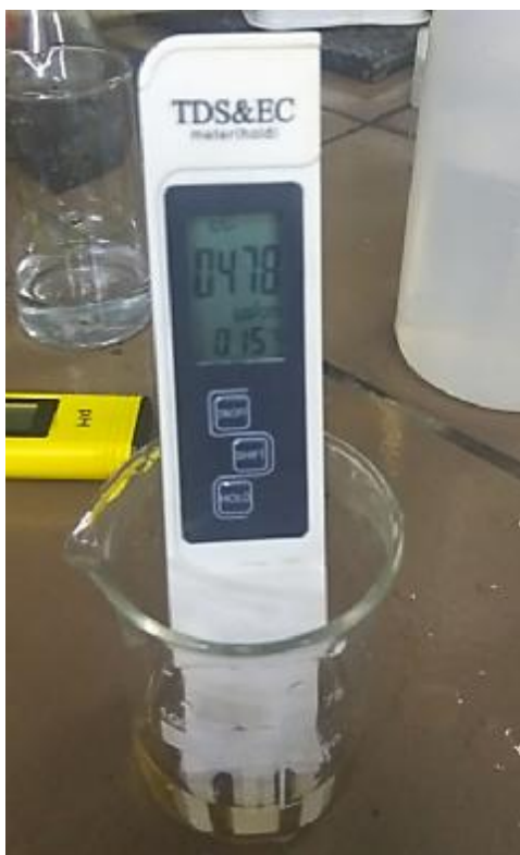
Рисунок 2.17 – Вимір TDS обробленого розчину метилфіолетового.
