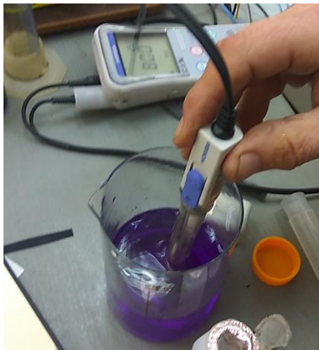
Рисунок 2.5 – Вимір рівня рН підготовленого розчину.
