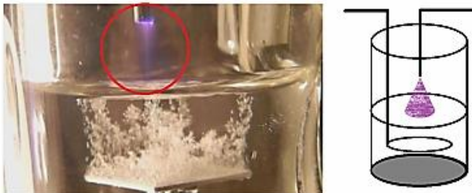
Рисунок 1.5 – Фотографія і схематичне зображення виникнення тліючого розряду по поверхні рідини.
