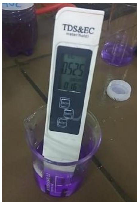
Рисунок 2.16 – Вимір TDS модельного розчину метилфіолетового.
