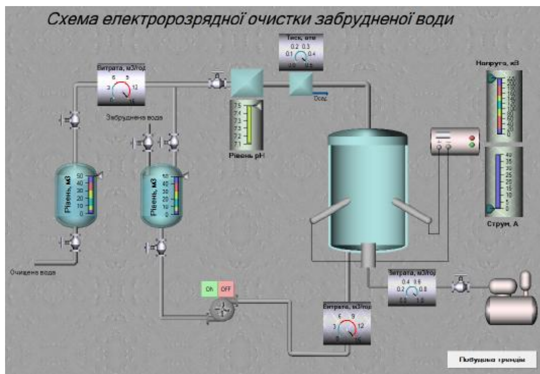
Рисунок 4.1 – Технологічна схема електророзрядної очистки води у Trase Mode 6.
