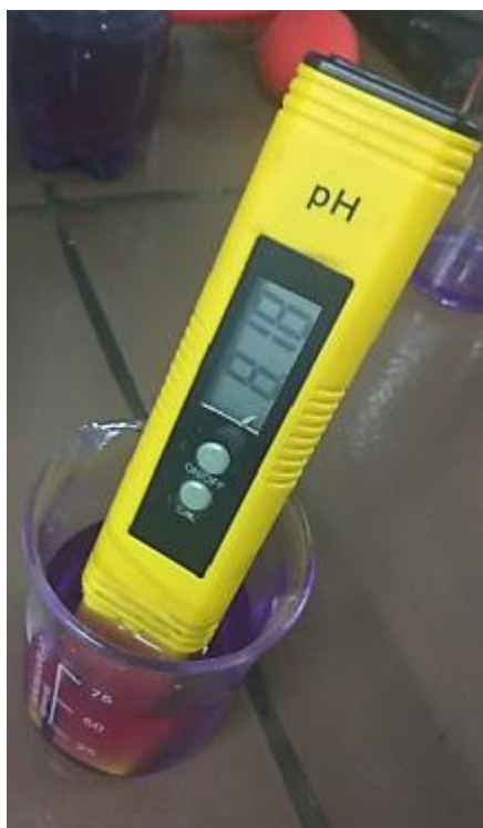
Рисунок 2.14 – Вимір рівня рН модельного розчину метилфіолетового.
