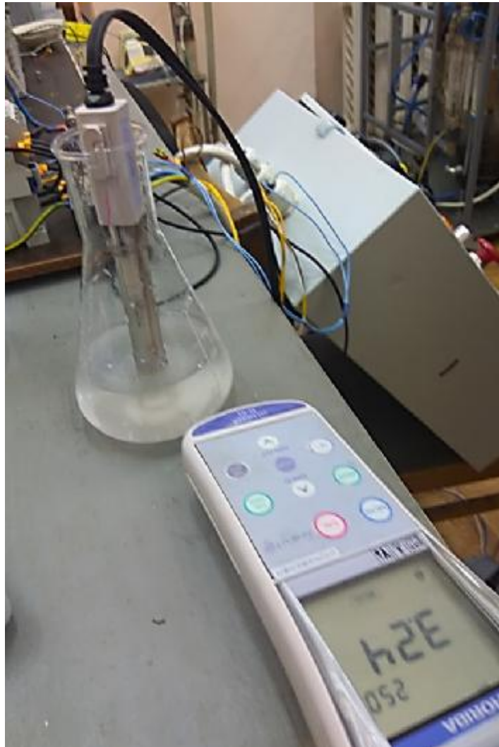
Рисунок 2.13 – Вимір рівня рН очищеного розчину.
