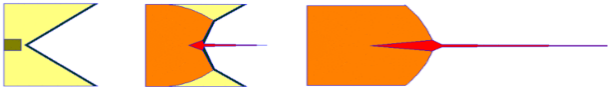
Рисунок 1.9 – Схема утворення кумулятивного струменя
