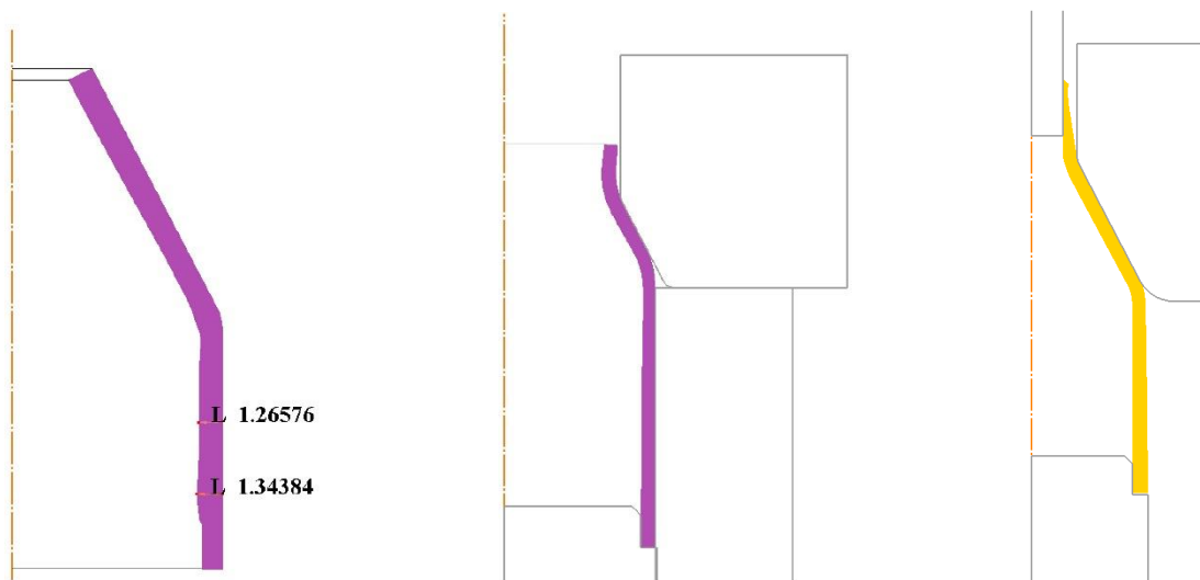
Рисунок 3.3 – Невдалі спроби моделювання при отриманні кумулятивної воронки гранатометного пострілу 40 мм
