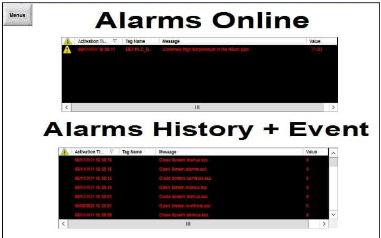
Рисунок 3.39-Робота системи попередження та логування подій у розпалі випробувань полігонних
