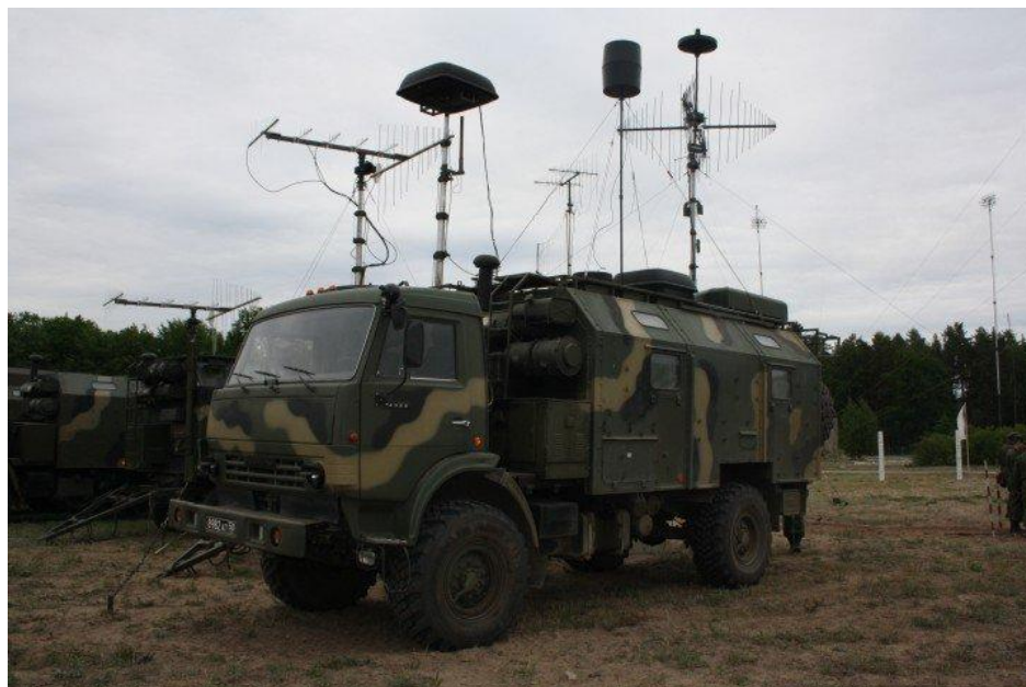
Рис. 2.27. Станція РЕБ, шифр “Шиповник-Аэро”
