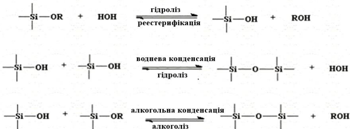
Рис. 1.1. Схема золь-гель процесу: гідроліз, воднева конденсація та алкогольна конденсація
