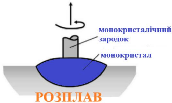
Рис. 4.3. Витягування монокристалів методом Киропоулоса [9]
