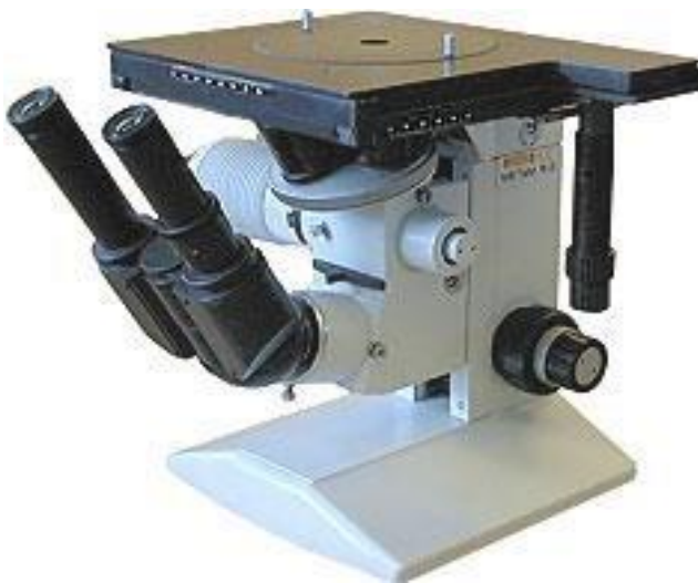
Рисунок 2.3 – Металографічний мікроскоп МЕТАМ з верхнім розташуванням предметного столику [39]
