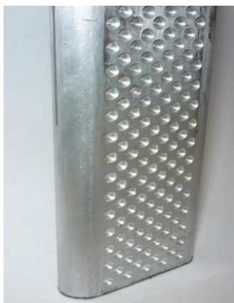
Рис. 15. Конструкція плоскоовальної труби з лунками
