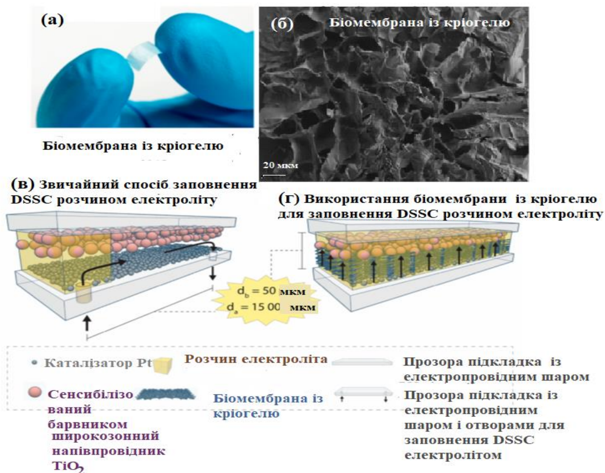
Рисунок 2.54 – Фотографія гнучкої біомембрани із кріогелем наноцелюлози (а); зображення СЕМ біомембрани (б); структура DSSC без біомембрани із кріогелю і процесу заповнення його електролітом (в); структура DSSC і процесу заповнення його електролітом у разі використання біомембрани із кріогелю (г)
