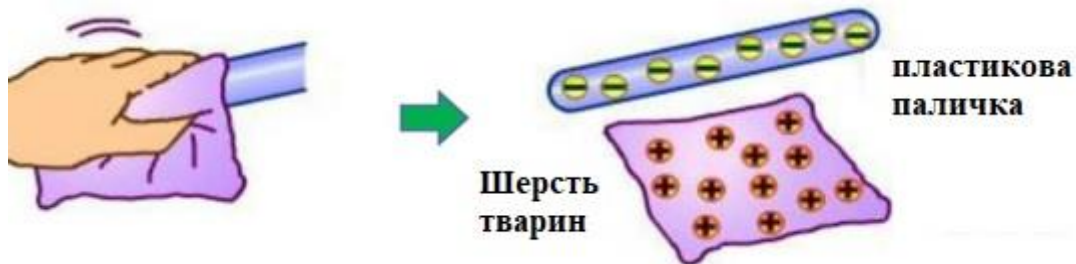
Рисунок 2.1 – Схематичне зображення процесу трибоелектризації
