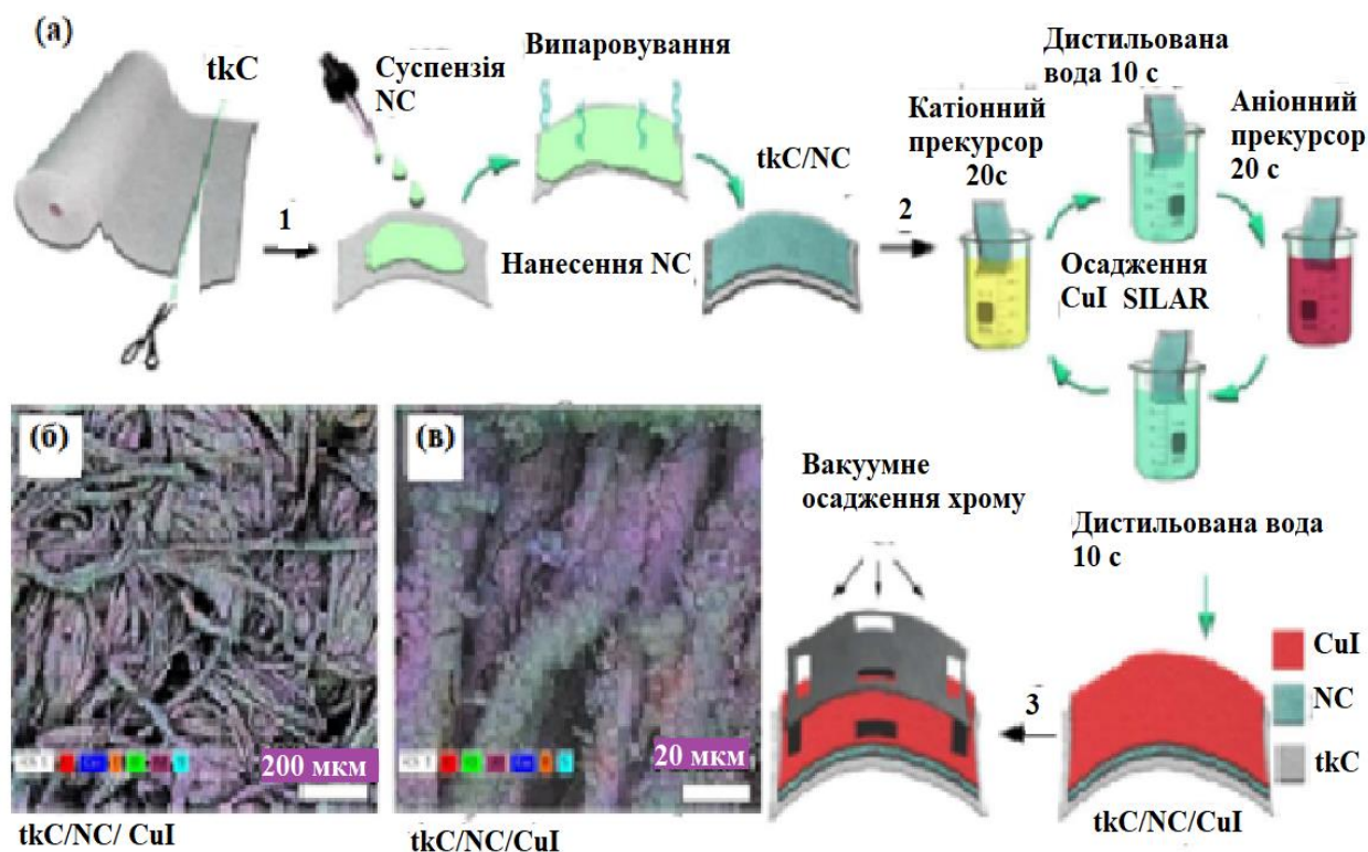
Рисунок 2.41 – Процес виготовлення текстильного елемента tkC/NC/CuI (а): 1 – створення нанокompозиту tkC/NC; 2 – виготовлення термоелектричного текстилю tkC/NC/CuI; 3 – формування tkC/NC/CuI шляхом оснащення ТЕ матеріалу тонкоплівковими омичними хромовими контактами; карти EDS термоелектричного текстилю tkC/NC/CuI (б, в)
