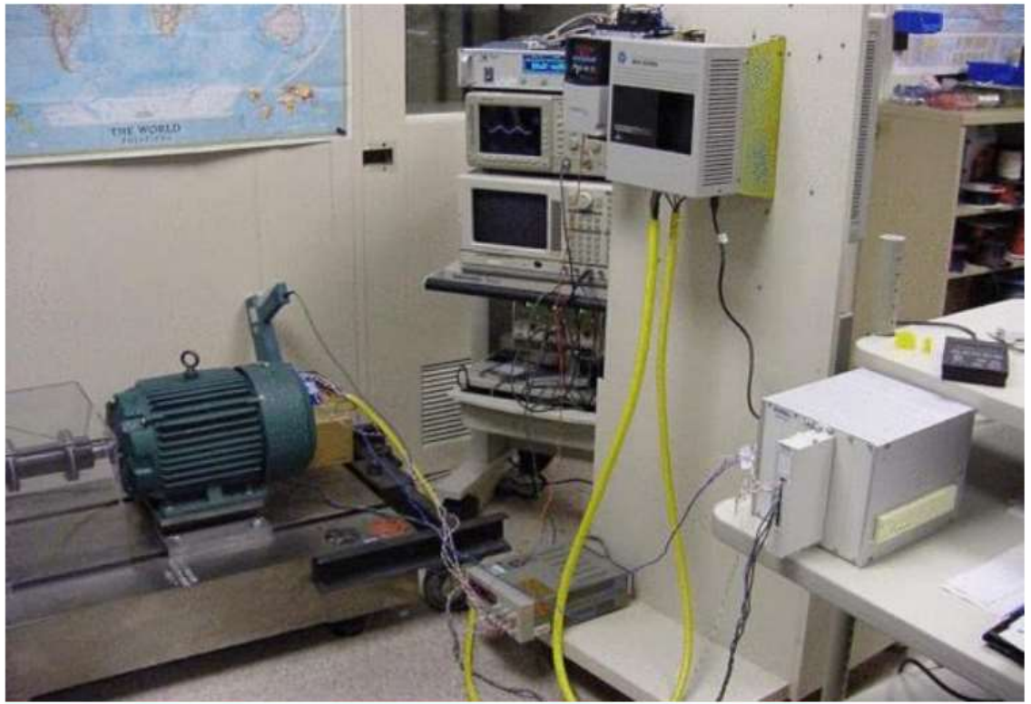
Рисунок 1.7 - Лабораторне випробування асинхронного двигуна потужністю 5 к.с. та збір даних [9]
