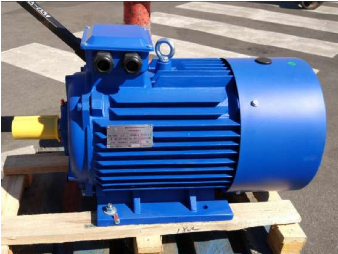
Рисунок 2.2 – Двигун 4А112М2У3 потужністю 7.5 кВт, із двома парами полюсів та кількістю пазів z=22 [12]
