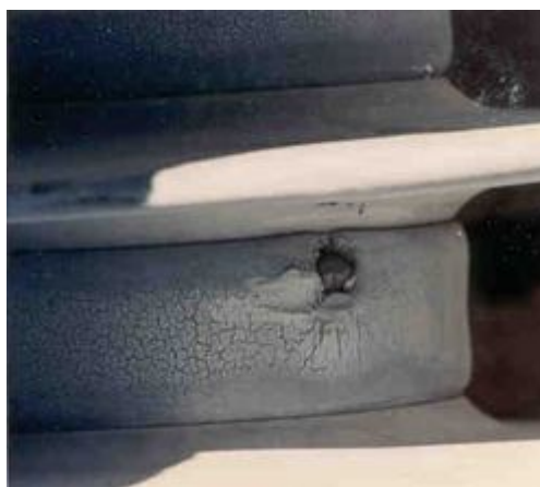
Рис. 1.46. Пошкодження з оголенням утримуючого склопластикового стрижня
