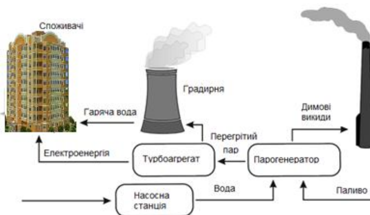
Рис. 1.100. Технологічна схема роботи теплофікаційної електричної стнції опалювального типу
