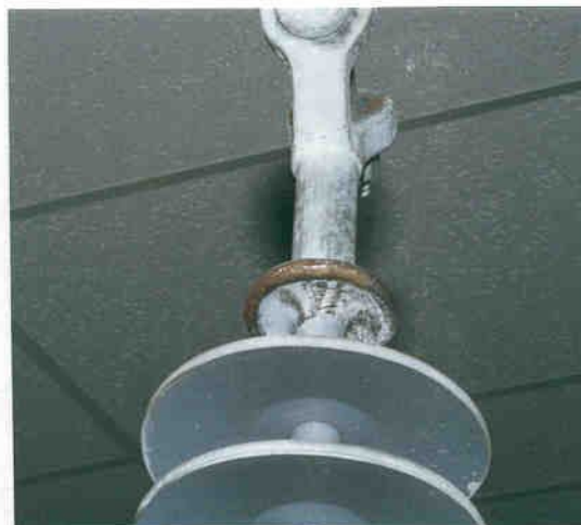
Рис. 1.42. Пошкодження наконечників унаслідок горіння дуги
