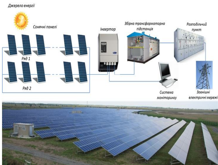
Рис. 1.105. Сонячна електрична станція: а – безпосереднього перетворення; б – теплофікаційна (17 000 дзеркал, 165-метрова башта з парогенератором, T = 566\text{ }^{\circ}\text{C} )
