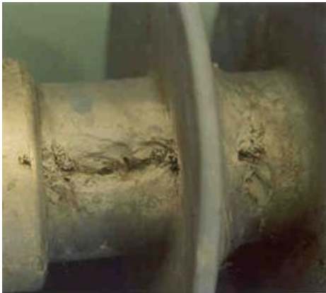
Рис. 1.50. Поверхнева ерозія полімерного покриття
