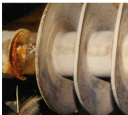
Рис. 1.47. Пошкодження корозією наконечників стрижня
