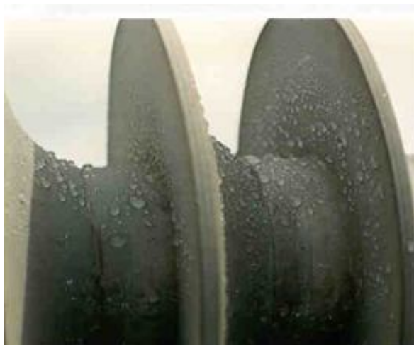
Рис. 1.40. Ізолятори з різною гідрофобністю
