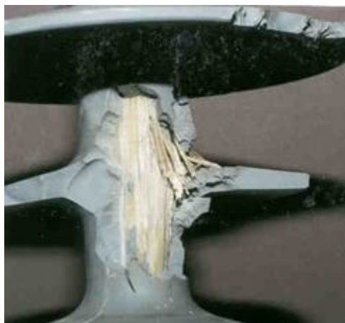
Рис. 1.45. Пошкодження утримуючого склопластикового стрижня
