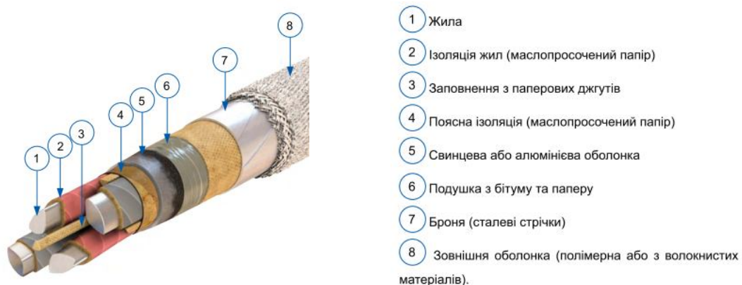
Рис. 1.60. Кабель з паперовою маслопросоченою ізоляцією з неекраниваними жилами
