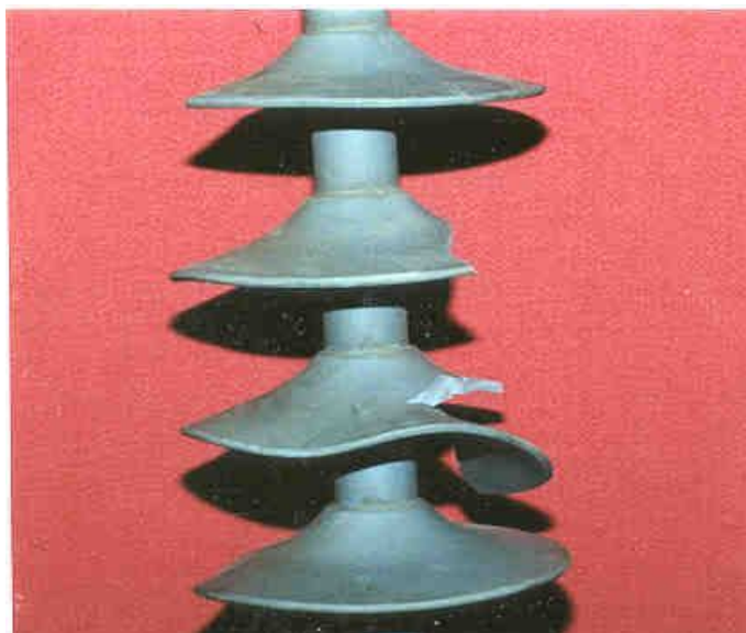
Рис. 1.41. Ізолятор із незначними механічними пошкодженнями
