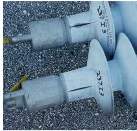
Рис. 1.49. Поверхневі тріщини з оголенням склопластикового стрижня
