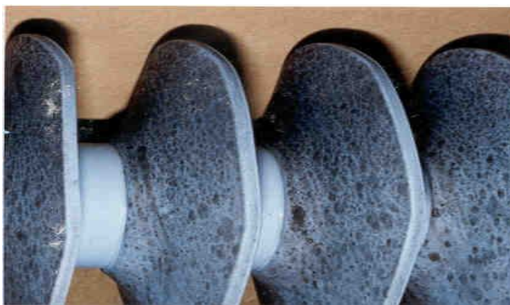
Рис. 1.39. Ізолятор, пошкоджений пліснявою
