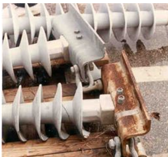
Рис. 1.43. Корозія на кінцях ізолятора
