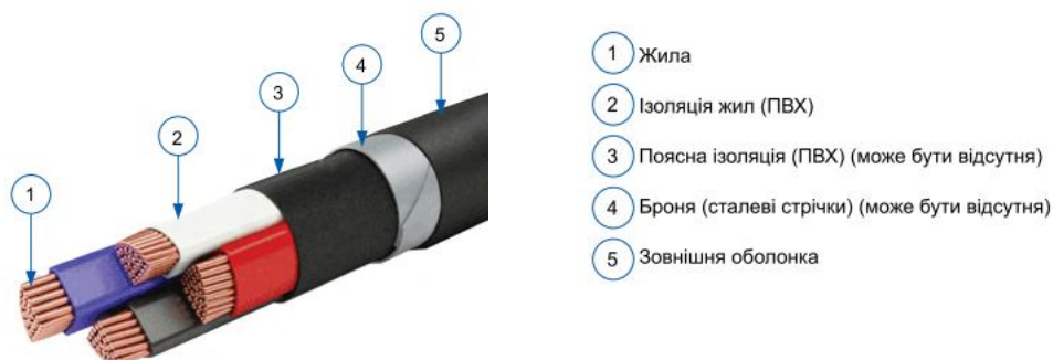
Рис. 1.58. Кабель із ПВХ-ізоляцією та неекранованими жилами
