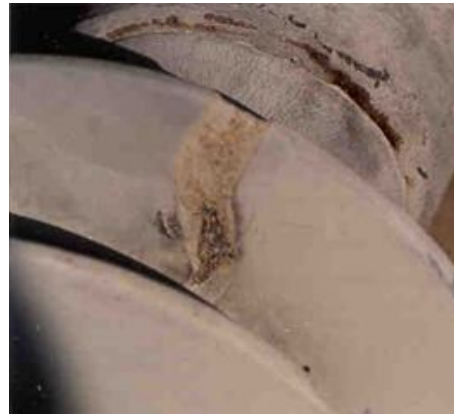
Рис. 1.50. Поверхнева ерозія полімерного покриття
