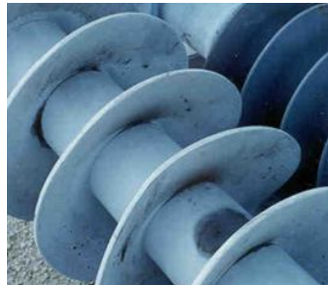
Рис. 1.37. Ізолятори з витоком наповнювача у місці з'єднання
