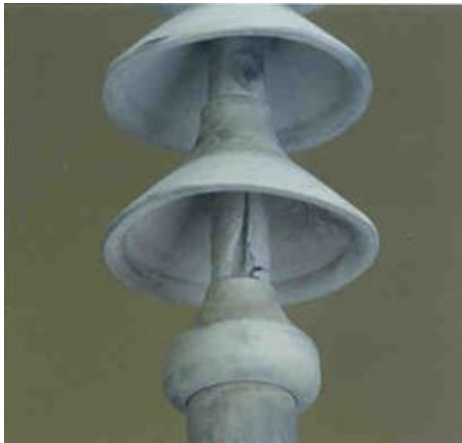
Рис. 1.49. Поверхневі тріщини з оголенням склопластикового стрижня
