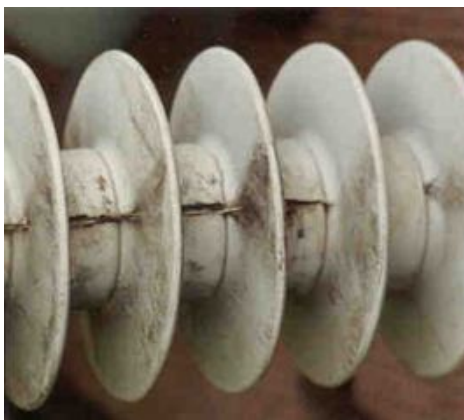
Рис. 1.51. Наслідки поверхневого пробію полімерного покриття ізолятора
