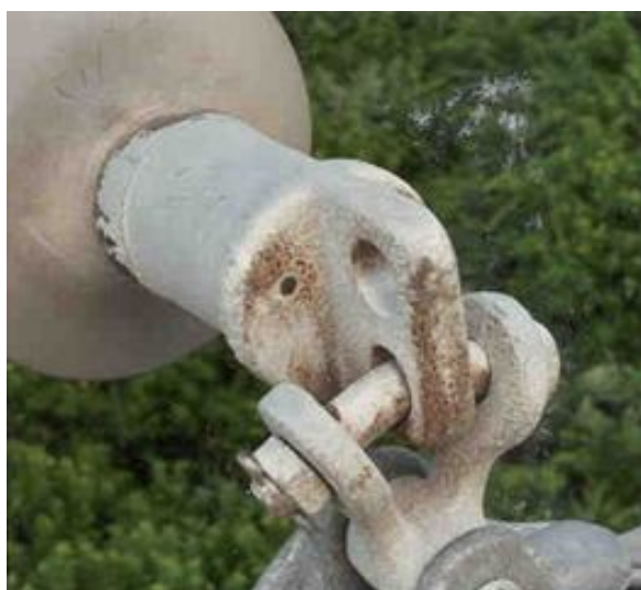
Рис. 1.43. Корозія на кінцях ізолятора
