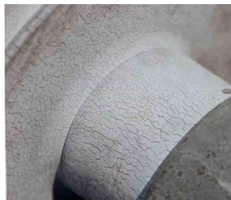
Рис. 1.48. Тріщини на поверхні ізолятора глибиною понад 0,1 мм
