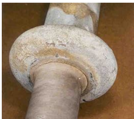
Рис. 1.47. Пошкодження корозією наконечників стрижня
