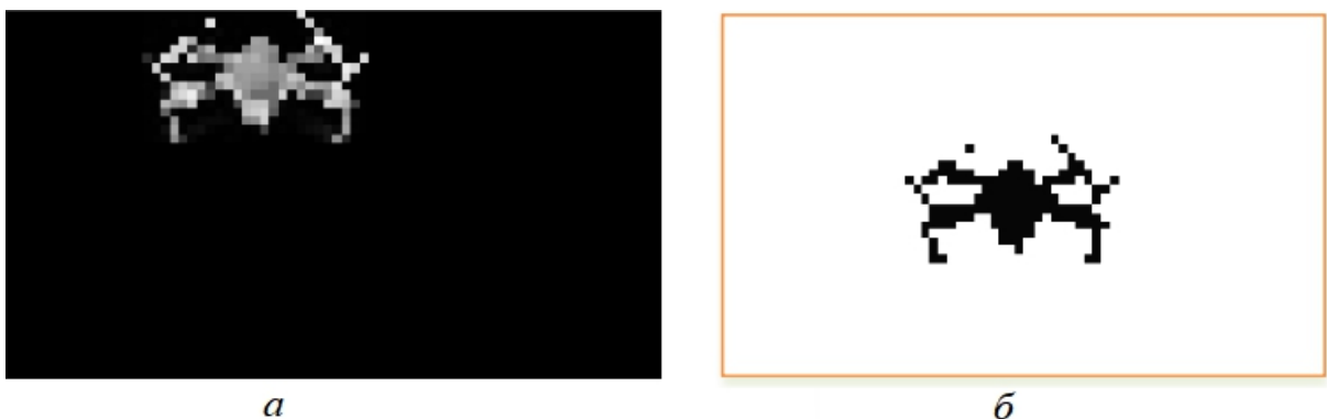
Рис. 5.2 – Різницеве і бінарізоване різницеве зображення в стробі супроводу
