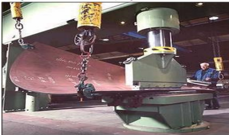
Рис. 1 технологія механічного формування в суднобудуванні.
