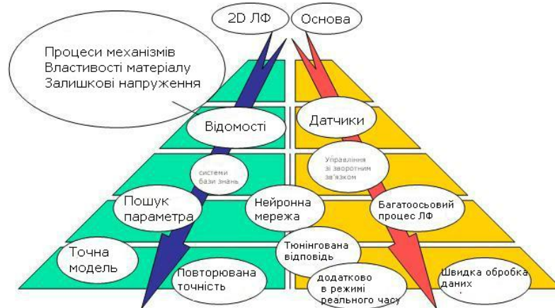
Рис. 2 описує маршрути і ключові елементи, необхідних для практичної реалізація 3D лазерного формування.
