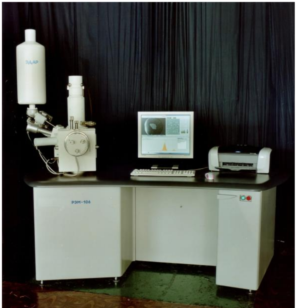
Рисунок 2.3 – Растровий електронний мікроскоп PEM-106
