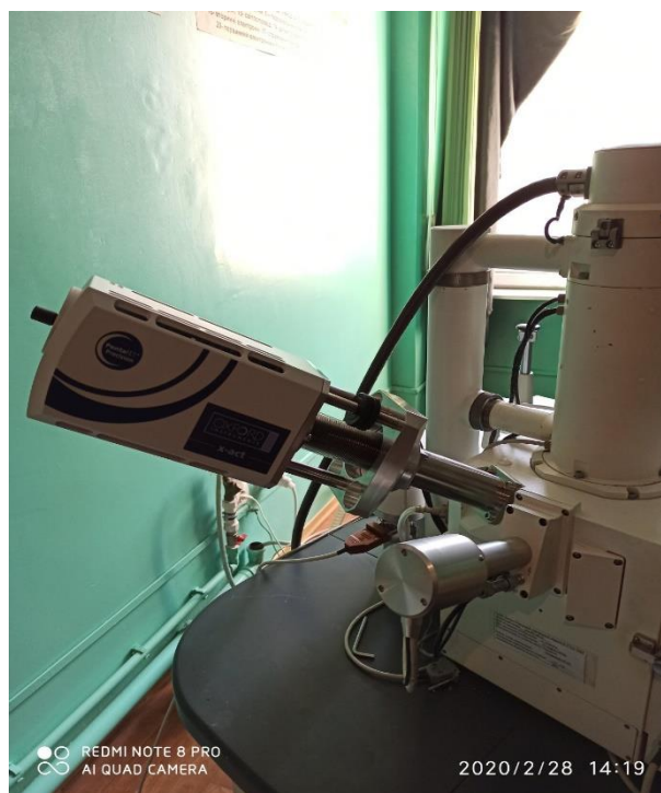
Рисунок 2.4 – Мікрорентгеноспектральний аналізатор Oxford X-Max20
