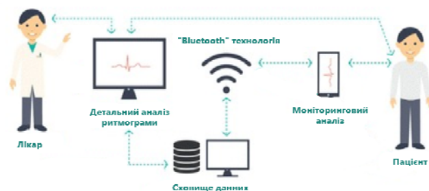
Рис. 5. Діаграма принципів компонентів апаратно-програмного комплексу для моніторингового аналізу ритмограм
