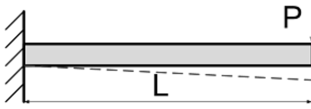
Рис. 4.1. Консольний згин зразка: L – довжина зразка, P – навантаження на зразок
