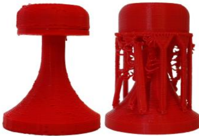
Рис. 1.8 – Результати друку 5-осьового принтера (зліва) у порівнянні із звичайним друком з підтримками (справа). [5]
