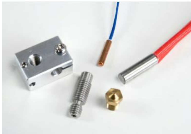
Рис. 2.10 – Складові частини гарячого кінця: нагрівальний блок, термобар'єр, термістор, сопло та нагрівальний картридж. [15]
