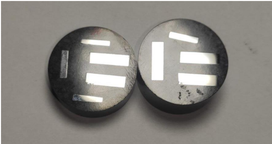
Рисунок 2.6 – Мікрошліфи запресовані в графітовий бакеліт
