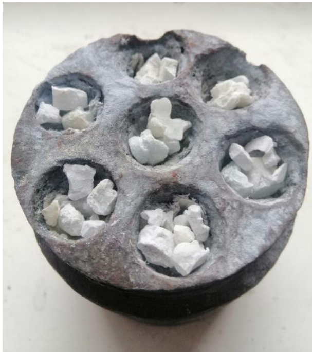
Рисунок 2.3 – Зовнішній вигляд контейнера для нанесення хромоалітованих покриттів
