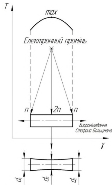
Рисунок 3.3 – Схема до пояснення причин виникнення поздовжнього градієнту температур при електронно-променевому нагріві
