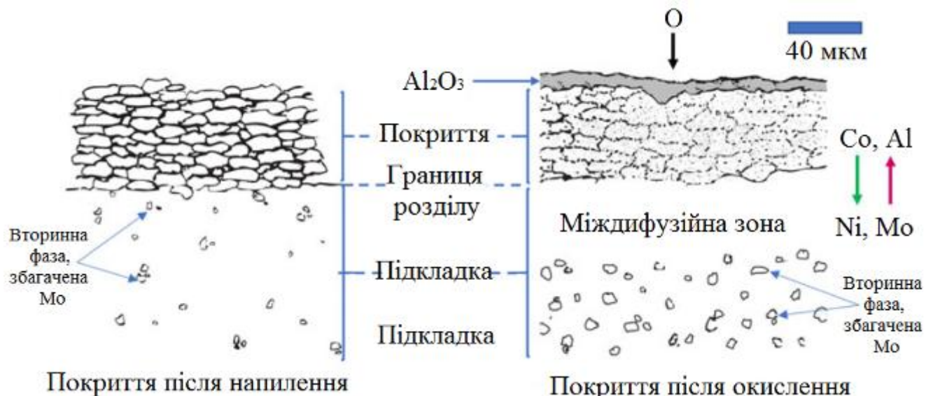
Рисунок 1.14 – AlCoCrFeNi покриття, отримане методом холодного газодинамічного напилення при температурі та тиску потоку стисненого повітря 400 °С та 10 бар, відповідно [67]
