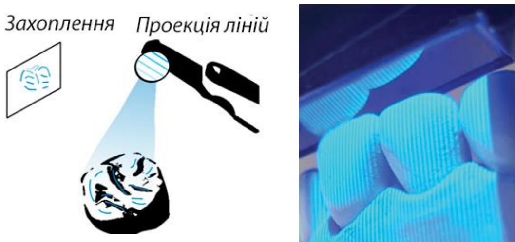
Рис. 1.15. Проекція сітки внутрішньоротовим сканером. [13]
