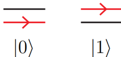
Рисунок 3 - Двоканальний фотонний кубіт. В залежності від того в якому каналі знаходиться фотон, стан кубіту є |0\rangle або |1\rangle
