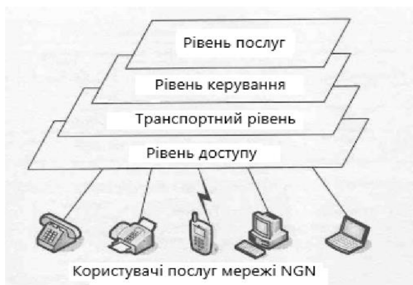
Рисунок 2.1 - Базова архітектура мереж наступного покоління NGN (згідно з Рекомендацією МСЕ-Т У.2001)
