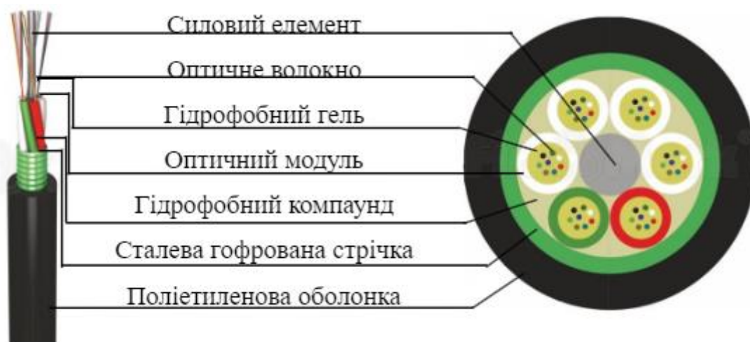
Рисунок 4.9 - Складові оптоволоконного кабелю FinMark LT004-SM-04
