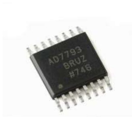
Рис. 2.7. Зовнішній вигляд мікросхеми AD7793BRUZ у корпусі TSOP-16
