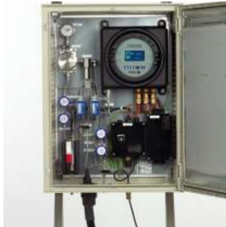
Рис. 1.5. Зовнішній вигляд комплексу вологоміра Michell Promet EExd, у якому використовується керамічний датчик
