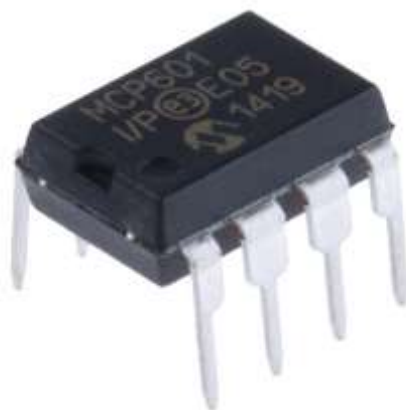
Рис. 2.5. Зовнішній вигляд мікросхеми MCP601-I/P у корпусі DIP-8
