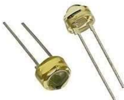
Рис. 2.4. Зовнішній вигляд фотодіоду ФД263-01
