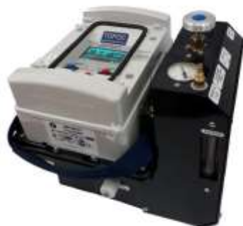
Рис. 1.13. Зовнішній вигляд конденсаційного гігрометра Торос 3-2В, який має у своєму складі напівпровідниковий оптичний датчик
