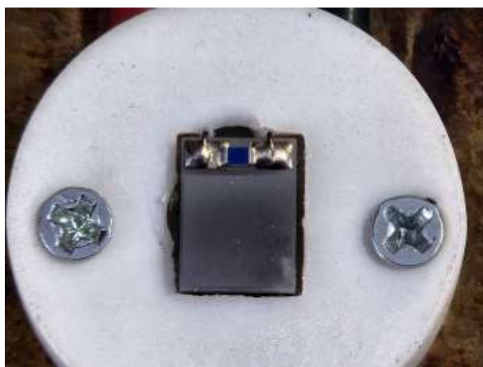
Рис. 3.26. Термістор, встановлений на конденсаційну поверхню всередині вимірювальної гігрометра
