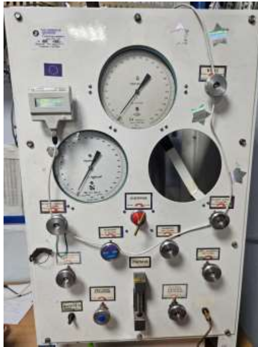
Рис. 3.27. Зовнішній вигляд генератор вологого газу ГВГ-2М
