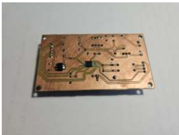
Рис. 3.24. Виготовлена друкована плата зі встановленими елементами, тильна сторона
