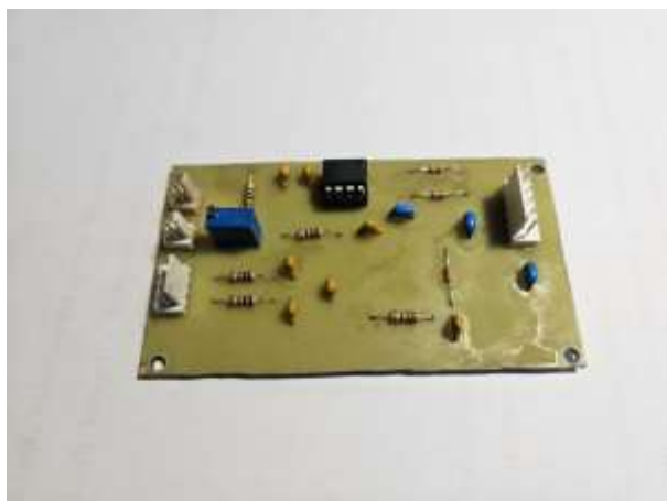
Рис. 3.23. Виготовлена друкована плата зі встановленими елементами, лицьова сторона
