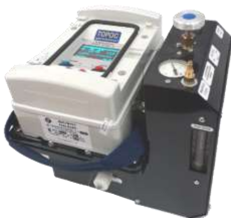
Рис. 1.1. Приклад зовнішнього вигляду гігрометра для природного газу
