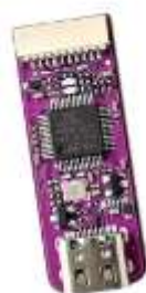
Рис. 3.7. Зовнішній вигляд програматора STLink v2.1
