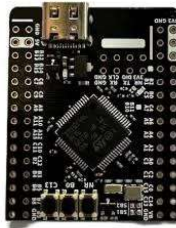
Рис. 2.13. Зовнішній вигляд модуля STM32F446RET6
